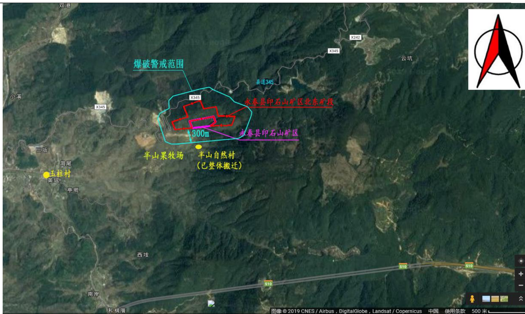
图 5.2-3 爆破警戒范围及敏感目标示意图
