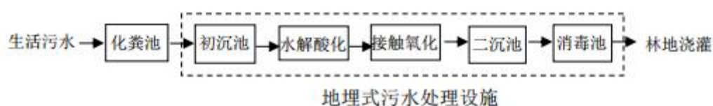
图 4-1 项目生活污水处理工艺流程图
